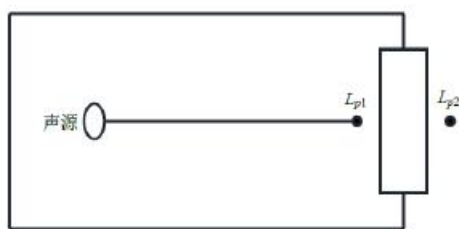
图4-2 室内声源等效为室外声源图例
